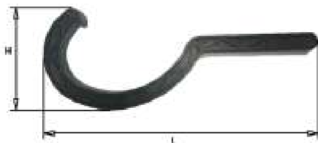
Рисунок 24. Ключ накладной для компрессионных фитингов ф 75-110
